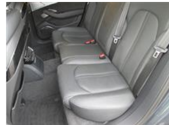
Abb: 11 Verfärbungen, Risse
